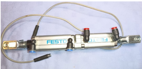
FESTO dvoradna pneumatska cilindra na zadnjem dijelu spojena (ADVU-16-40-A-P-A i ADVU-16-30-A-P-A)
