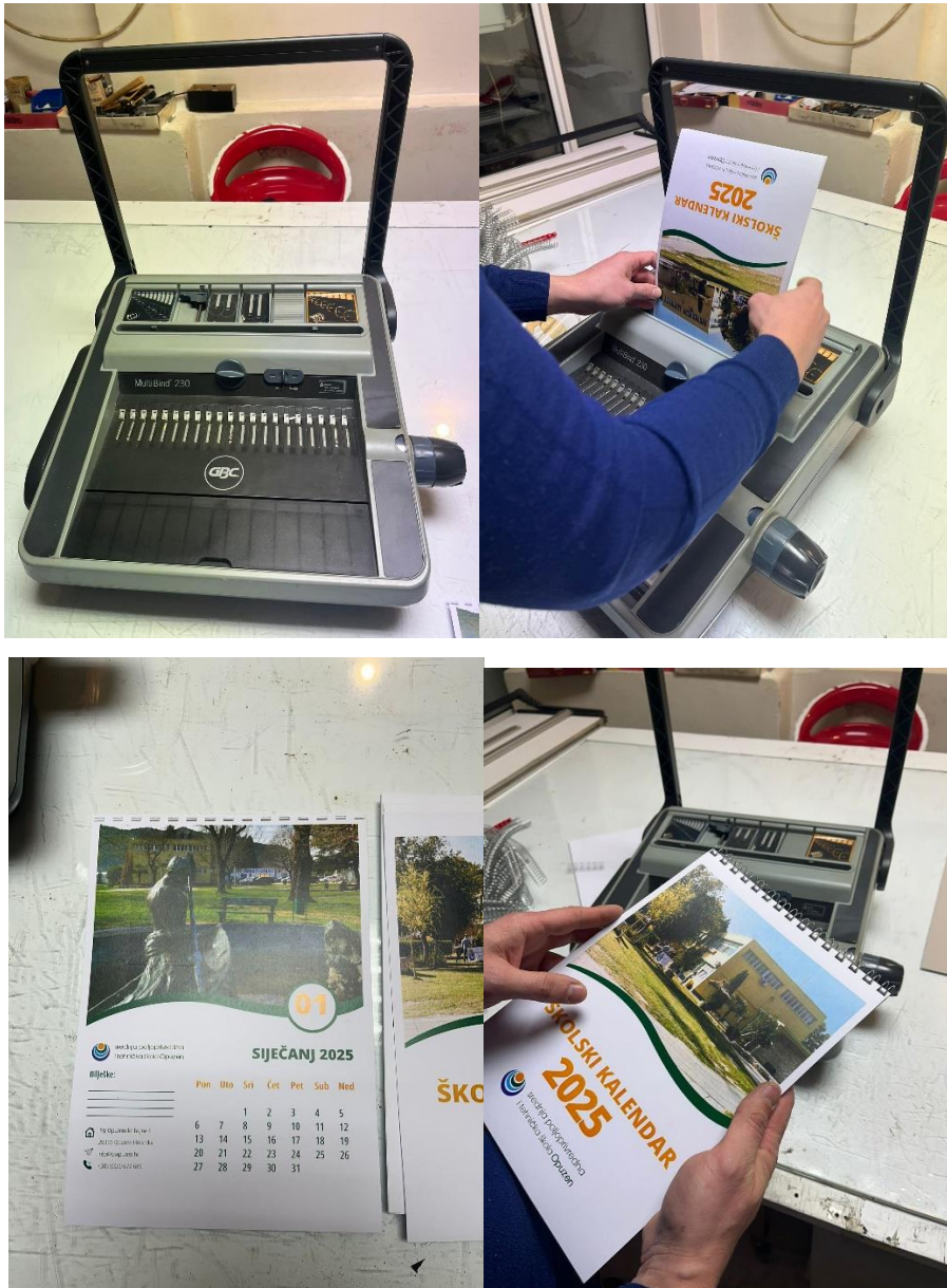
Slika 15.,16.,17. i 18. Prikaz stroja za spiralni uvez, izrezivanje, postavljanje žičane spirale na zidni kalendar.
